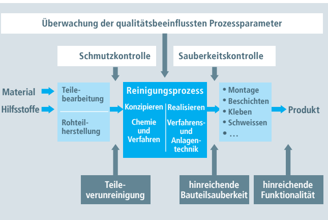
Abbildung 2: Analyse der Prozesskette (Quelle: SITA Messtechnik GmbH)
